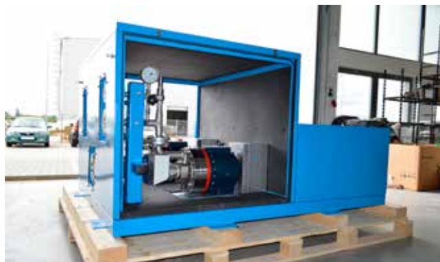
» Zabudowa dwóch pomp G35 do warunków zewnętrznych Pompowanie kondensatu
